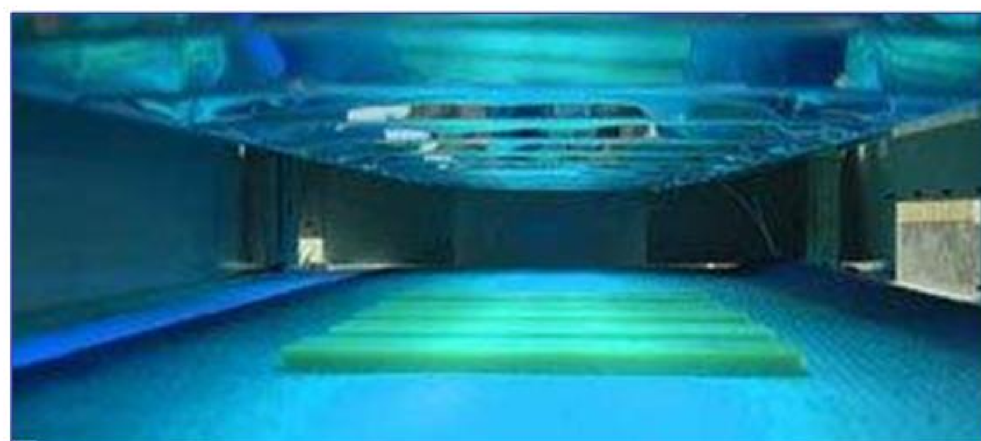
Tratamiento superficial en el cual los materiales de piso para calzado son sometidos a una radiación ultravioleta que produce una modificación química de la superficie del material, aumentando su energía superficial y mejorando su afinidad por el adhesivo
