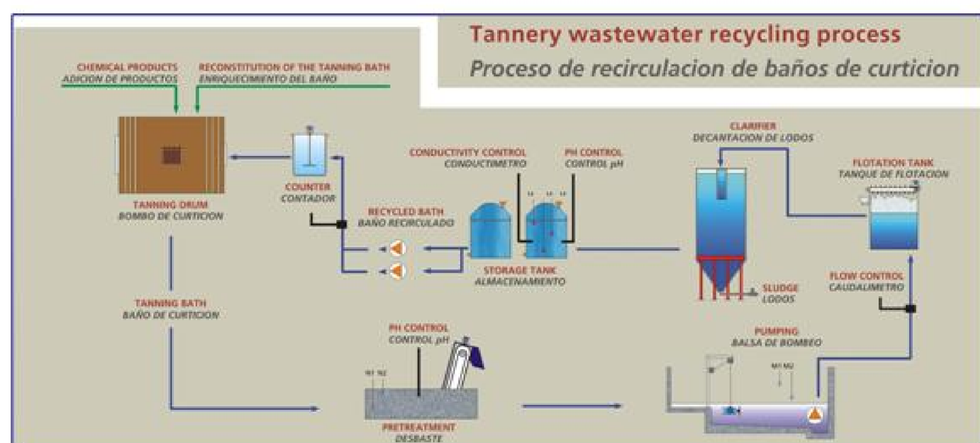
Reciclaje de baños de piquel y curtición permitiendo un ahorro de un 97% de agua en dichos procesos, 55% de sales, 21% de ácido fórmico y 14% de cromo.
